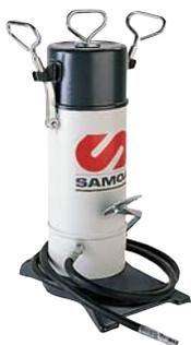
Bomba de engrase muy robusta, accionamiento muy confortable a pedal. Para todo tipo de grasas. Con émbolo de compactación de grasa empujado por muelle para utilización con las grasas más duras. Presión máxima: 500 bar. Entrega por ciclo de pedal: 2 grs. Depósito estanco, muy robusto y fácilmente transportable, de capacidad 5 Kg. Bomba con purgador de aire, flexible de alta presión de 2 m (140 200) y boquilla con válvula (121 020).
