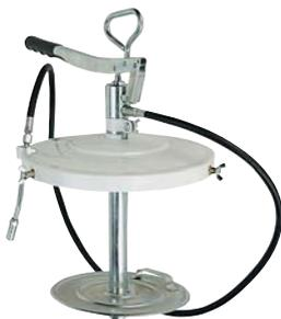
Bomba de engrase construida en acero para acoplamiento directo sobre bidones originales de grasa. Presión máxima: 350 bar. Entrega por ciclo: 2 cc
